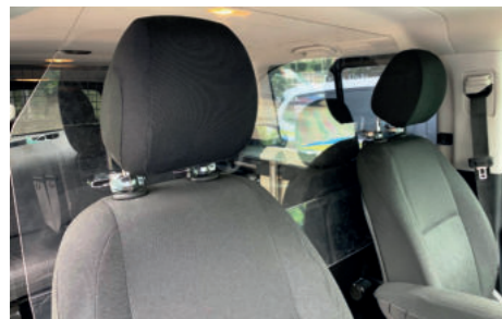
Zusätzlichen Infektionsschutz bietet die Trennschutzscheibe.
